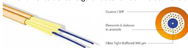
Cavo in fibra ottica di tipo tight
