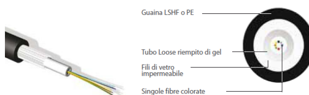
Cavo in fibra ottica di tipo loose
